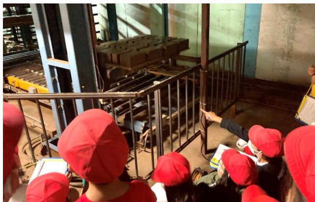
▶ 乾燥後のレンガは 2 階から 1 階にリフトで降ろされ、1 個 1 個選別し窯に入れられます
